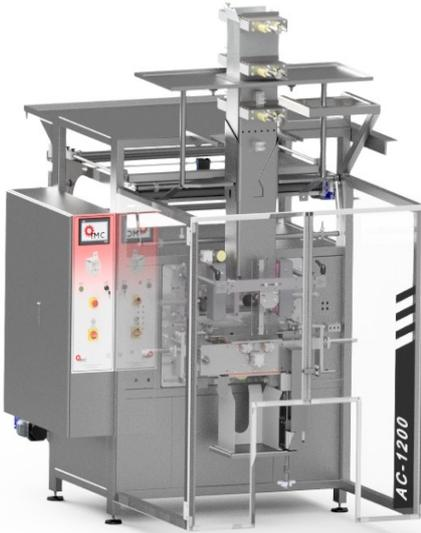
El modelo AC-1200, es una embolsadora vertical diseñada para la creación de sacos confeccionados a partir de bolsas de hielo o de otro tipo de productos. Adicionalmente, la ensacadora AC-1200 se integra con una serie de complementos que se le incorpora según la necesidad del producto a envasar necesario por parte del cliente, facilitando así la solución más perfecta que el cliente necesita.
