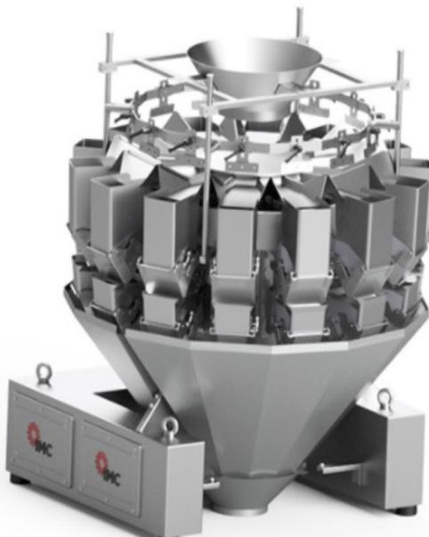
El modelo multicabezal de 14 pesadoras, es un sistema de multi pesaje circular compuesto por 14 cangilones de pesado que se encargan de realizar combinaciones entre ellos, para llegar al peso que le hemos indicado aproximándose lo máximo posible y minimizando el baremo de peso consiguiendo así unas pesadas muy precisas.
