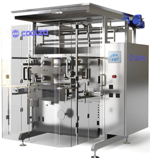
Un sistema de túnel de doble cinta asegura que la distribución del producto, dentro de la bolsa, es homogéneo y que la posición dentro del saco será perfecta. Especialmente relevante en la industria del hielo, ya que el formato de distribución más habitual de bolsas de hielo es mediante la agrupación de bolsas de 1 o 2 kilos en sacos de 4 o 5 bolsas.
